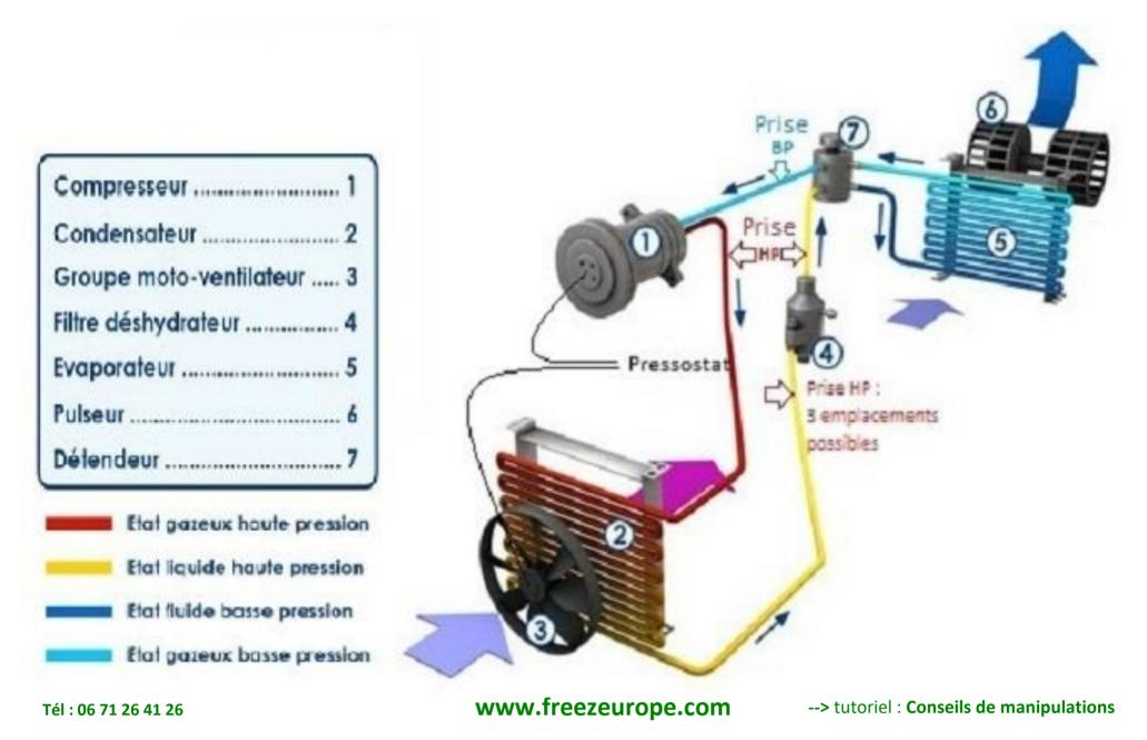
Pressions suivant la Température ambiante à la bonne charge du R134a R1234yf et/ou Duracool ou GreenFreeze :
